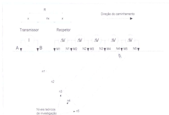
Figura 5.1 – Esquema de arranjo dipolo-dipolo utilizado em caminhamentos elétricos.
